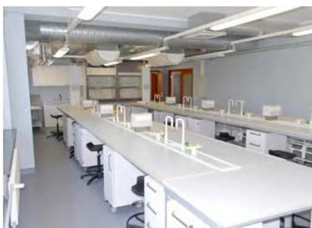
**Тип I** – островной стол без приподнятого модуля обслуживания
