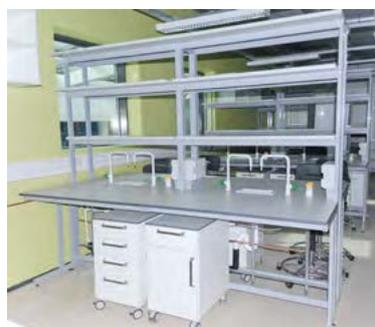
**Тип II** – островной стол с открытым в середине приподнятым модулем обслуживания. Он часто называется островным столом скандинавского типа.
