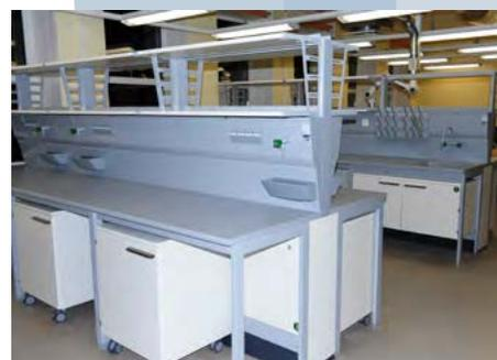
**Тип III** – островной стол с закрытым в середине приподнятым модулем обслуживания. Он часто называется и островным столом немецкого типа. Данный тип островного стола имеет больше всего возможностей и является для пользователя самым безопасным. Благодаря этому островной тип данного типа больше всего распространен в Европе.
