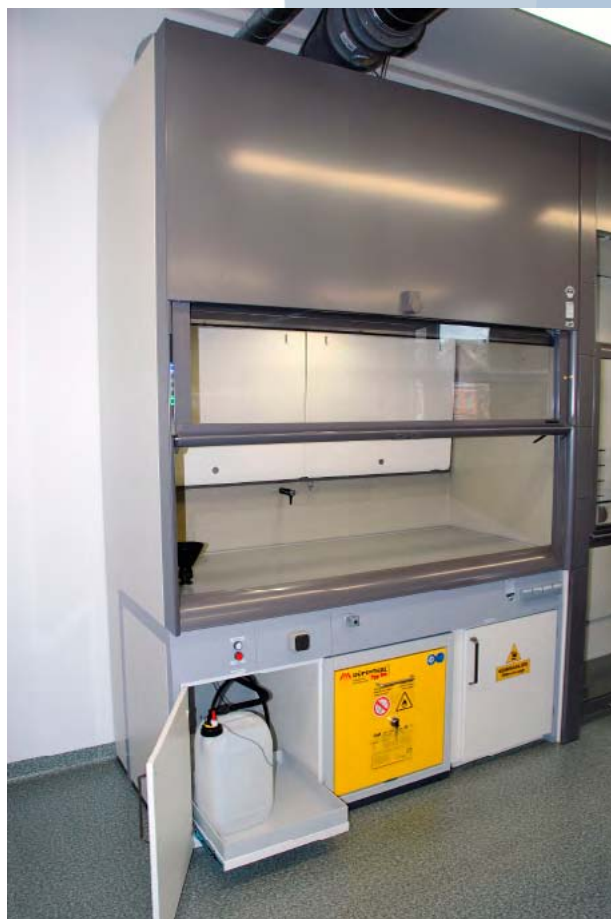
Polüpropüleeniga vooderdatud eriotstarbeline tõmbekapp koos keemiliste jäätmete kogumise süsteemiga tõmbekapist.
